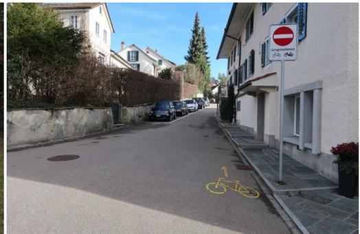
Abbildung 37: Einbahn mit Velo im Gegenverkehr, Veloführung im Mischverkehr bei engen Platzverhältnissen (Aufnahme Oberdorfstrasse)
