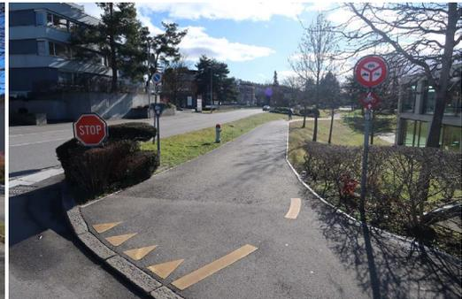
Abbildung 33: Unverträgliche Veloführung im Mischverkehr mit dem Fussverkehr (Aufnahme Rotfluhstrasse)
