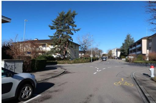
Abbildung 32: Verträgliche Veloführung im Mischverkehr bei Tempo 30 und tiefem DTV (Aufnahme Knoten Im Walder / Blumenrain)
