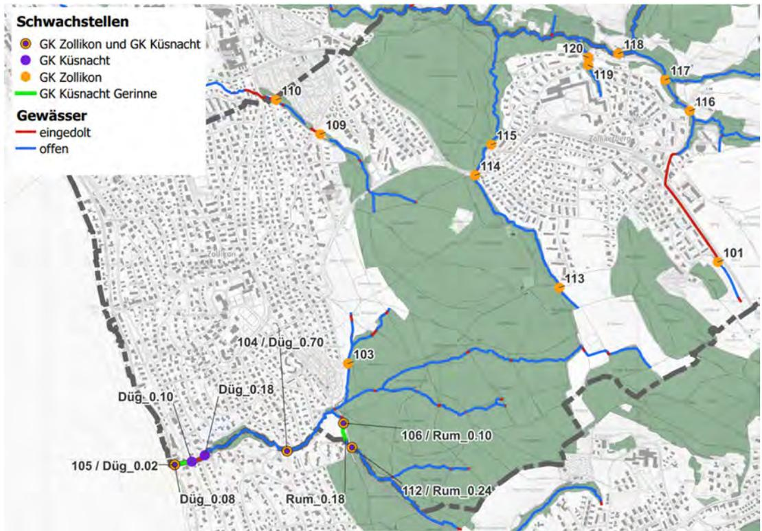
Abbildung 9: Schwachstellenkarte mit allen Schwachstellen im Perimeter von den Gefahrenkarten Zürichsee rechts und Küsnacht (maps.zh.ch)
