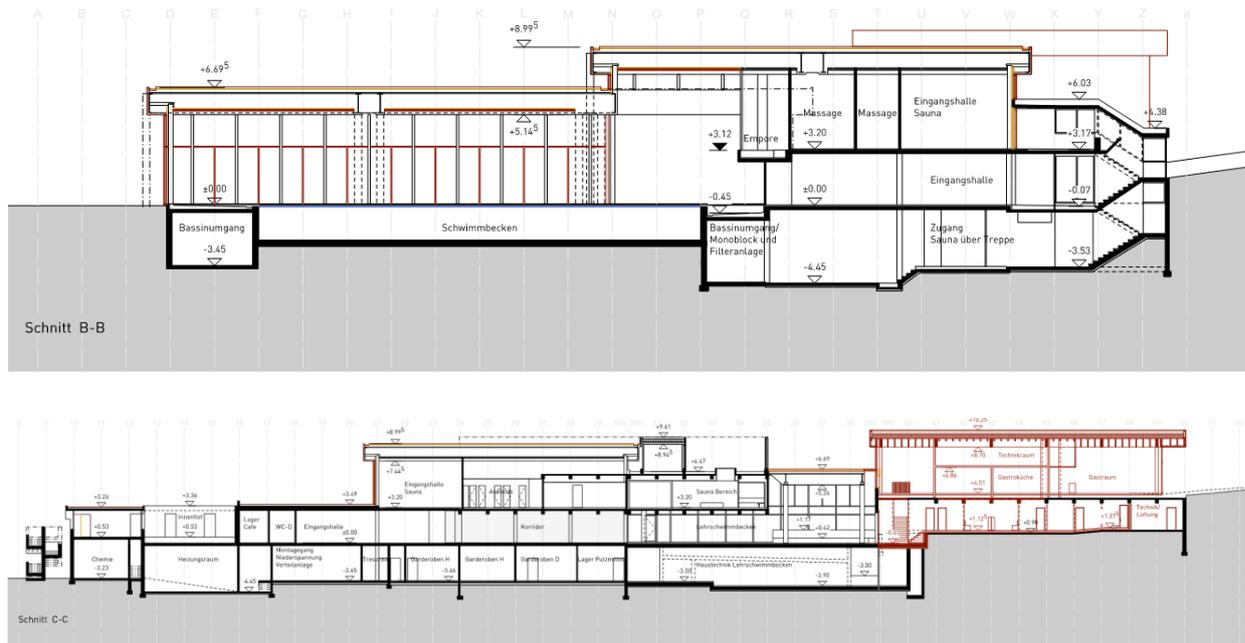
Bild 3 Querschnitt durch Schwimmhalle (oben) und Längsschnitt (unten) (Verkleinerungen).
