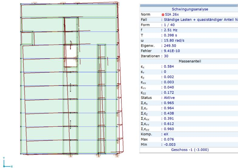
Bild 50 Schwimmbadgarderobe: 1. Eigenform in x-Richtung.  $T_1 = 0.398$  s,  $f_1 = 2.51$  Hz,  $\epsilon_y = 58.4\%$
