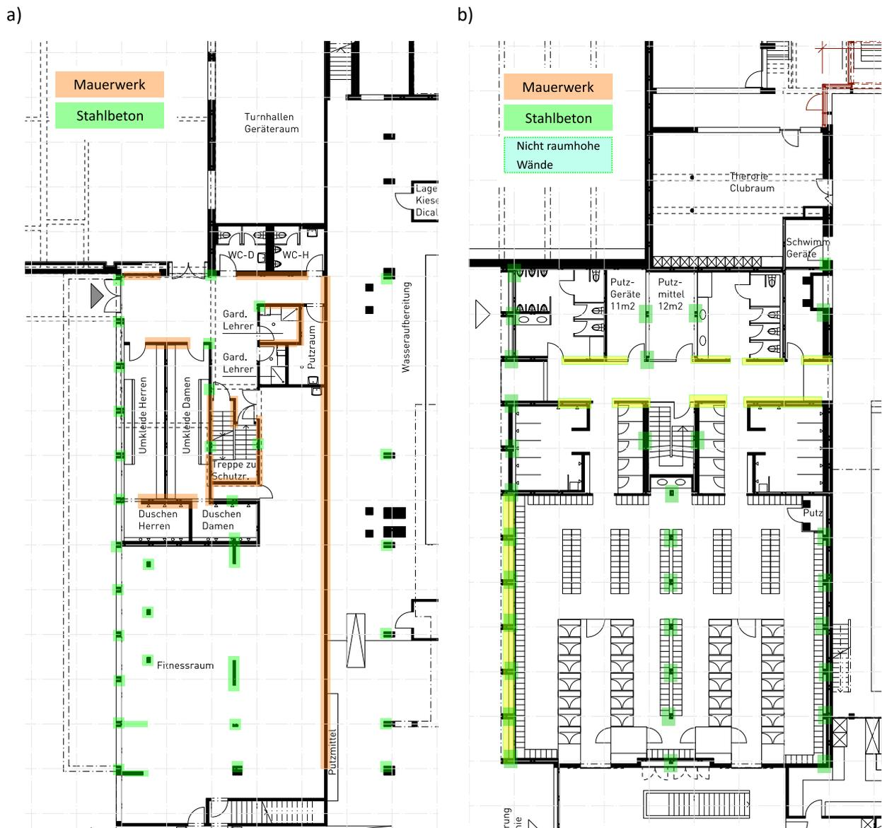
Bild 47 Stützen und tragende Wände Fitnessraum und Schwimmbadgarderobe, a) Untergeschoss b) Erdschoss
